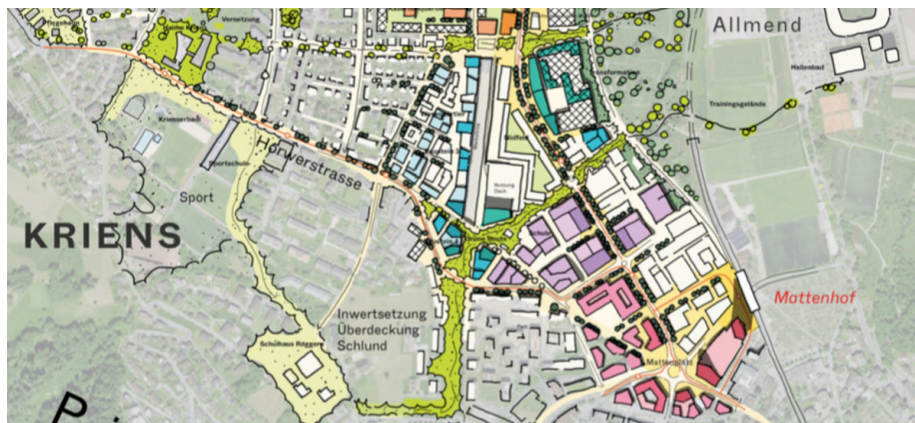
Der Entwurf sieht im mittleren Teil des Autobahn-Abschnitts eine grosse Überdachung vor. Zwei kürzere Autobahnabschnitte bleiben offen. (Bild: Team Van de Wetering)
